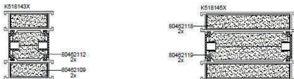
Rys.2. Izolacja kształtowników ramy obwodowej: a) w klasie EI30 , b) w klasie EI60
